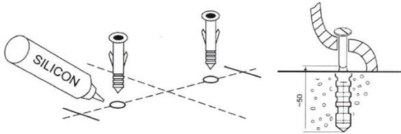
6.5. Уплотните место стыка постамента с поверхностью пола герметизирующей (силиконовой) массой с тем, чтобы предотвратить попадание воды под основание унитаза и ее дальнейшее проникновение в плиты перекрытия. Избыток массы удалите шпателем или пластиной из пластика.
