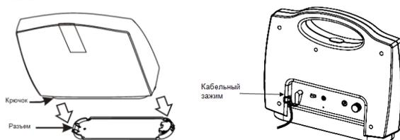
5.5. Подключите кабель питания в разъем питания на задней стенке устройства. Подключите адаптер к сети и переместите переключатель на устройстве в положение «вкл».
