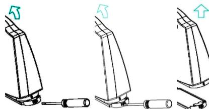
5.2. Вставьте отвертку в отверстие фиксирующего механизма в правой нижней части базовой пластины. Аккуратно надавите на фиксатор с помощью отвертки - это позволит отсоединить базовую пластину. Снимите блок устройства с базовой пластины.
