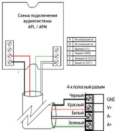
До 10 плат могут быть подключены к разъему 'outreach' (в комплекте) с помощью кабеля длиной до 100 м с использованием двужильных аудио кабелей типа Belden 8723 (см. схему подключения).
