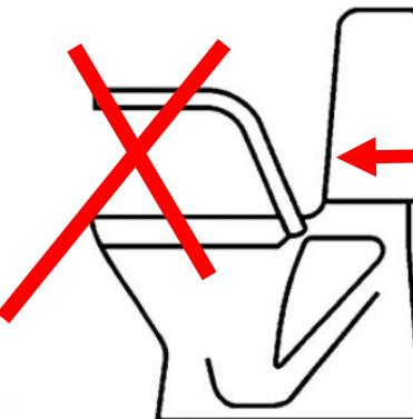
Поручни, установленные на унитазе могут применяться только для индивидуального использования с учетом веса пользователя и допустимой нагрузки на них, указанной в инструкции.
