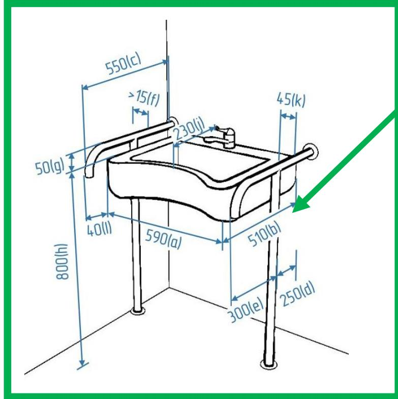
1. Опоры при напольном креплении поручней не должны быть расположены от его переднего края более чем на половину длины всего поручня
