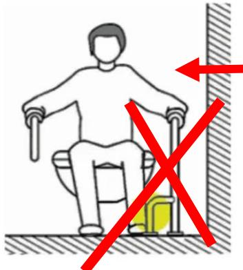
Недопустимо разворачивать дополнительную опору поручня в сторону унитаза, это создает травмоопасную ситуацию при вставании. За выступающие в зону движения опоры поручня можно зацепиться ногой и упасть.
