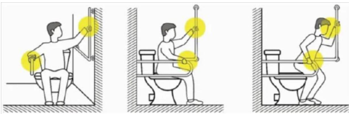
*Рисунок 7.2.1. L-образный настенный поручень, координация движений при вставании.*
